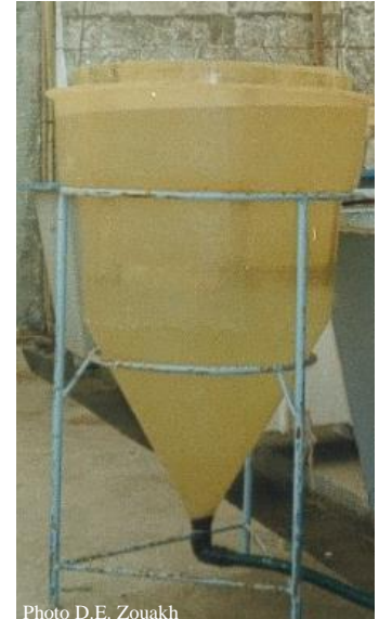
Figure 11 : Bassin cylindro-conique destiné à la croissance des alevins (C.N.R.D.P.A.)
